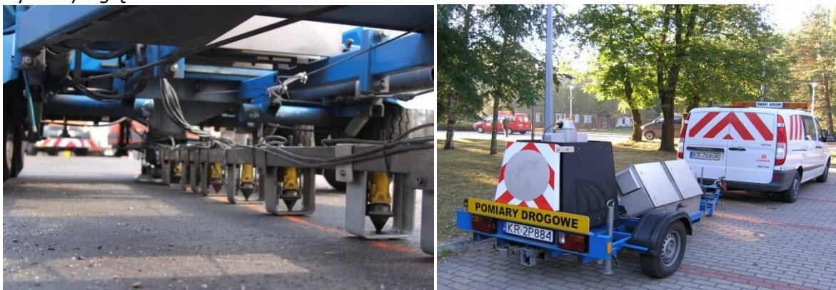
Fotografia 1. a) Geofony pomiarowe oraz płyta naciskowa; b) zestaw pomiarowy FWD
